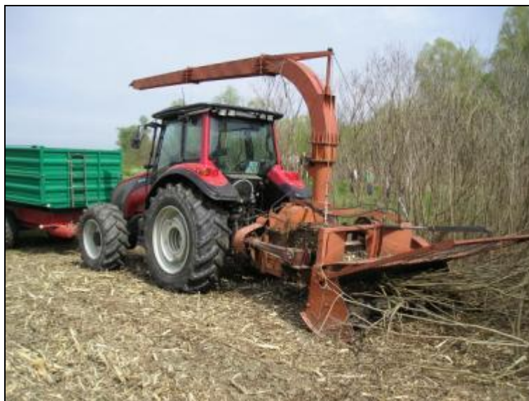
2.ábra. Járvaaprító kísérleti gép munka közben (a Gyártó fotója)
